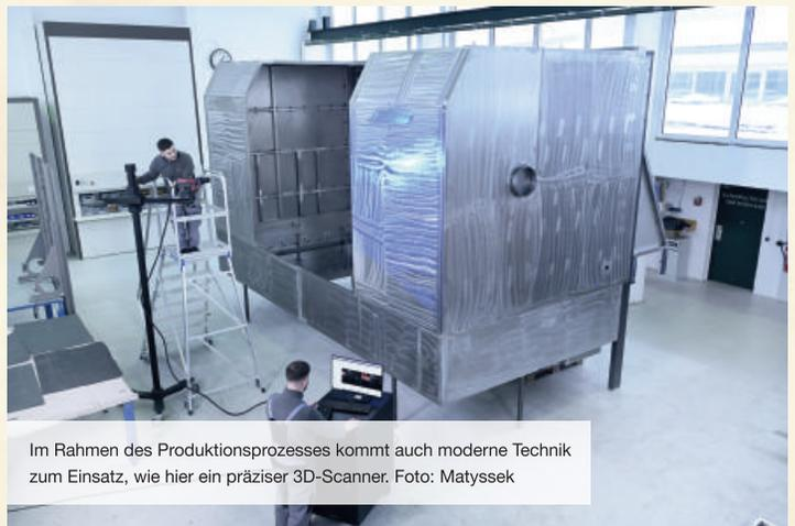
Im Rahmen des Produktionsprozesses kommt auch moderne Technik zum Einsatz, wie hier ein präziser 3D-Scanner. Foto: Matyssek
