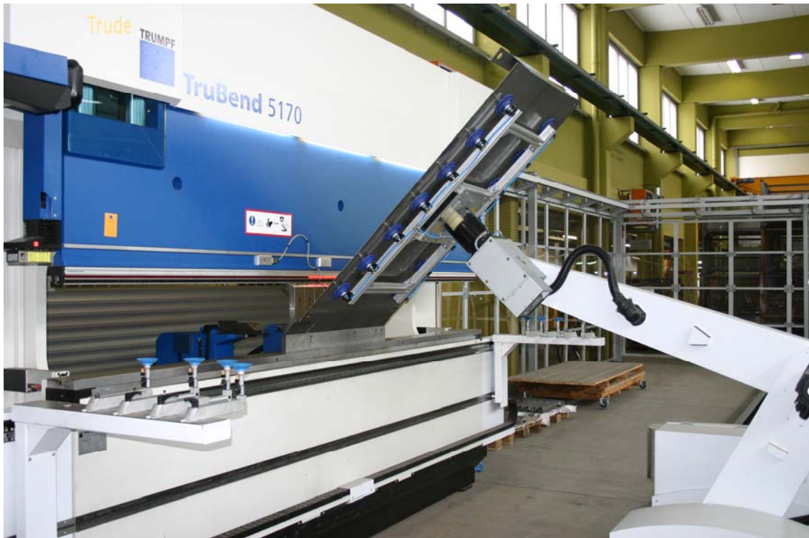
Gesenkbiegepresse mit Roboter, Tragkraft bis 150 kg
